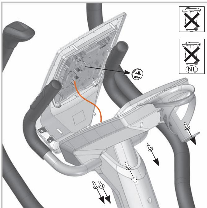
Eine schwache oder erloschene Computeranzeige macht einen Batteriewechsel erforderlich. Der Computer ist mit zwei Batterien ausgestattet. Nehmen Sie den Batteriewechsel wie folgt vor:
