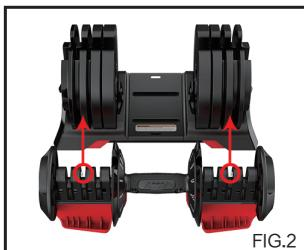
2. Ha van konvex pont, ellenőrizze a súlyzólemez helyzetét a konvex pont helyzetének megfelelően.
