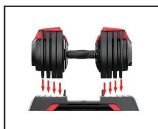
Stellen Sie sicher, dass jede Hantelplatte mit der entsprechenden Nut an der Basis ausgerichtet ist.
